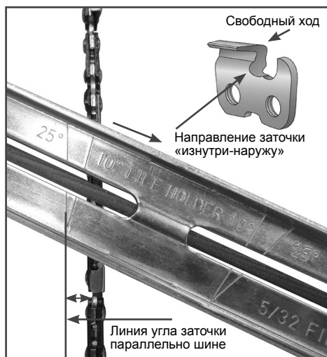
Рис. 22 Расположение линии угла заточки
