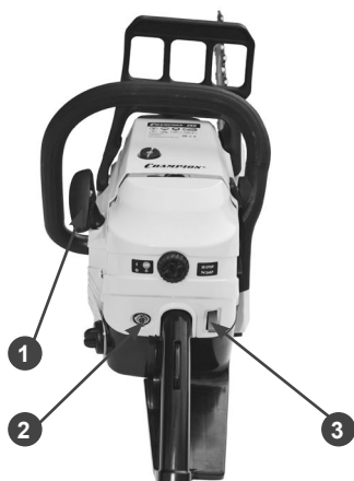
Рис.2 Основные узлы и органы управления (вид сзади)
