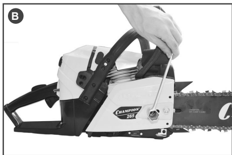
Рис. 5 Затяжка гайки крепления шины
