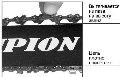
Рис. 6 Регулировка натяжения цепи
