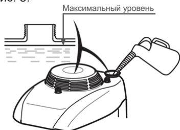
Рис. 8 Максимальный уровень топлива в топливном баке
